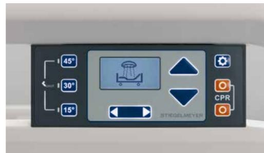
Die optimale Liegeflächen-Einstellung für die Waschanlage ist am Bedienpanel voreingestellt.
