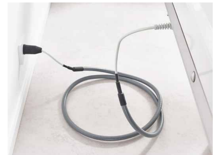
▲ Das Anacondakabel ist eine mit einer festen Ummantelung geschützte Netzleitung zur Verhinderung eines Missbrauchs durch suizidgefährdete Patienten.
